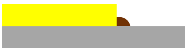
図 28 段差が大きい基板のディッピング後の C_{60} の想定される成長の様子
