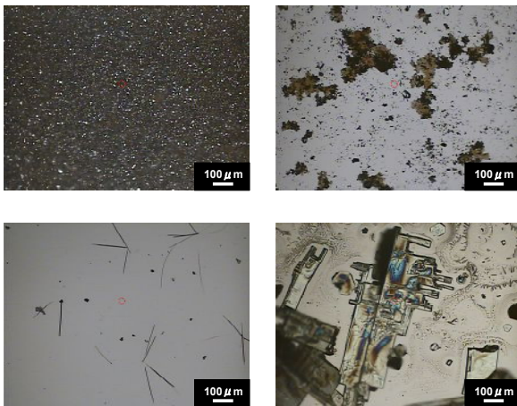
図 3. トルエンを溶媒とした時の過飽和溶液蒸発法顕微鏡像、基板角度(a) 0°, (b) 30°, (c) 60°, (d) 90°
